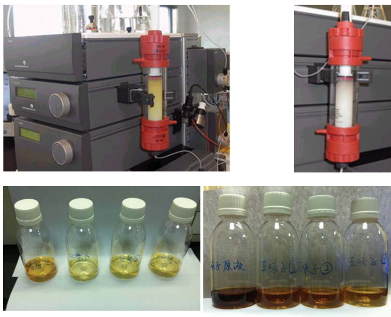
图10 Q Sepharose FF 去除色素，上柱后和清洗后的比较，样品上柱前和过柱后的比较。
