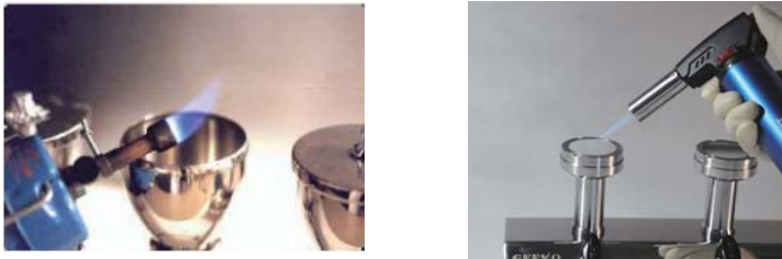
图1 传统方法需用火焰枪对漏斗和基座灭菌，需等待冷却，清洗步骤繁琐，可靠性差
