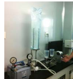
图2 GE医疗生命科学部Whatman MBS1微生物过滤系统，采用独特设计，可连续操作更多中药样本
